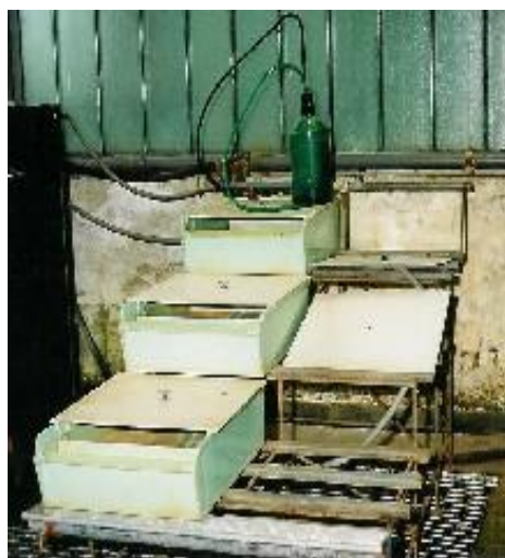
Рис. 4.13. Аппарат Шустера: 1 – наружный ящик; 2 – внутренний ящик; 3 – предохранительная решетка, 4 – сточный носик
